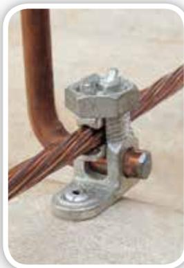
**Finalidade:** Conexão com cabos **CS - COPPERSTEEL** ou cobre. Utilizado para conectar um ou dois cabos à malha de captação com a telha metálica. Aterrar um ou dois cabos à estruturas de aço, caixas metálicas, chapas ou barramentos. Fixação de cabos de descida SPDA à alvenaria ou concreto.
