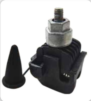
**Finalidade:** Conexão entre ramal de entrada (cabo de cobre flexível Classe-4/5 – isolamento PVC 450/750v - sem cobertura) e ramal de ligação (condutores de alumínio CA multiplexado – XLPE/PE 0,6/1kV – fase e neutro (isolado ou nu)).
