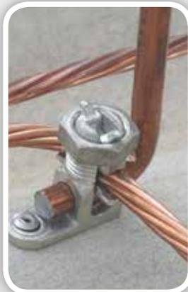
**Finalidade:** Conexão com cabos **CS - COPPERSTEEL** ou cobre. Utilizado para conectar um ou dois cabos da malha de captação com a telha metálica. Aterrar um ou dois cabos à estruturas de aço, caixas metálicas, chapas ou barramentos. Fixação de cabos de descida de SPDA à alvenaria ou concreto.
