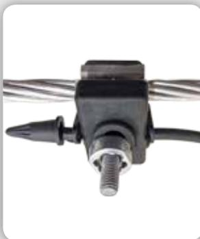
**Finalidade:** Derivação de cabos. Indicado para conexão na principal/tronco (rede nua) e derivação (rede isolada). Indicado para conexões alumínio-alumínio, alumínio-cobre ou cobre-cobre (baixa tensão até 1kV).
